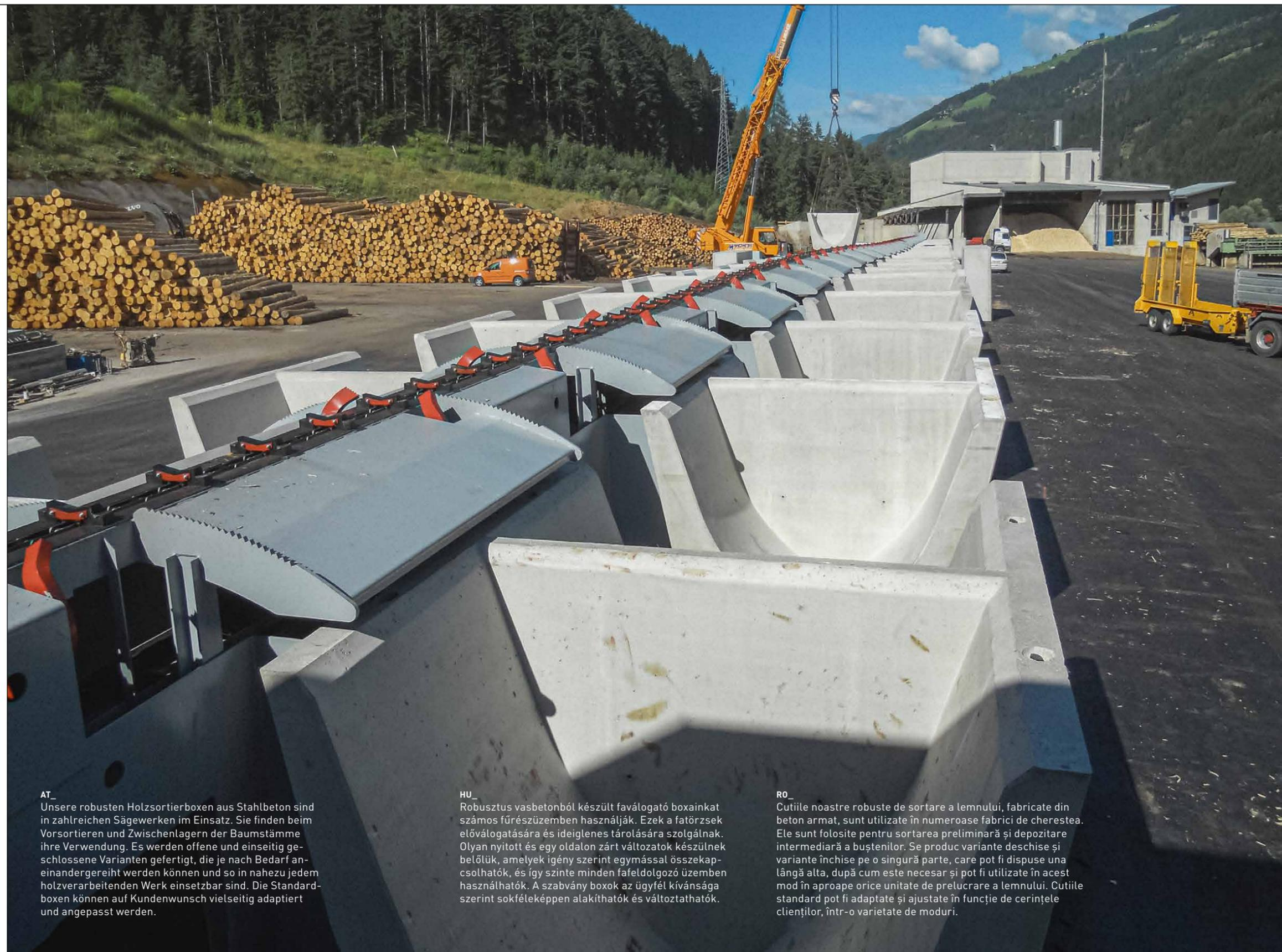
AT\_ Unsere robusten Holzsortierboxen aus Stahlbeton sind in zahlreichen Sägewerken im Einsatz. Sie finden beim Vorsortieren und Zwischenlagern der Baumstämme ihre Verwendung. Es werden offene und einseitig geschlossene Varianten gefertigt, die je nach Bedarf aneinandergereiht werden können und so in nahezu jedem Holzverarbeitenden Werk einsetzbar sind. Die Standardboxen können auf Kundenwunsch vielseitig adaptiert und angepasst werden.
